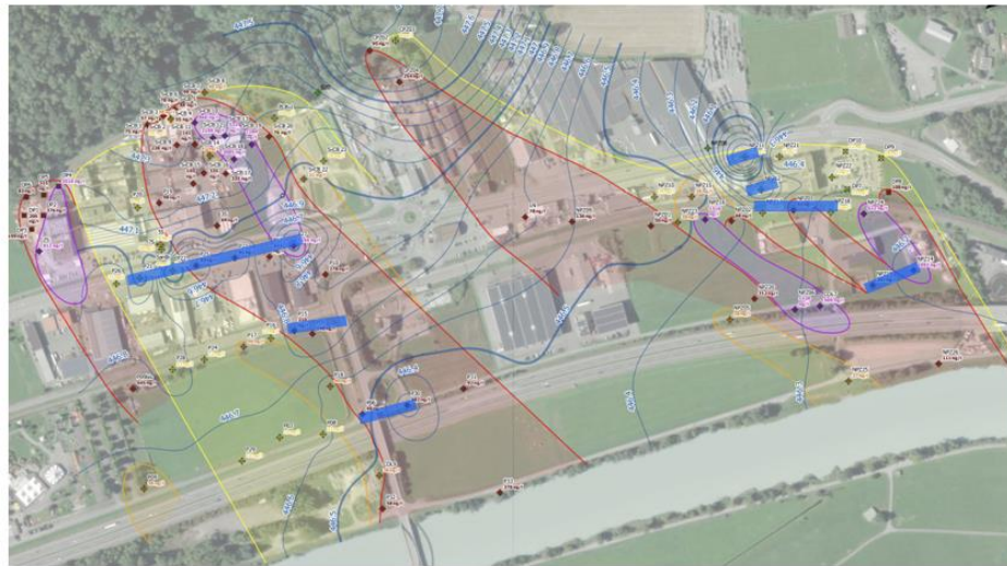
— Barrière de confinement hydraulique
